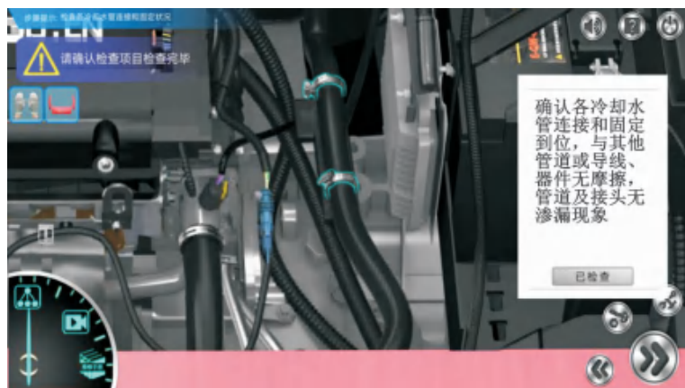
图 1-37 检查冷却水管路
