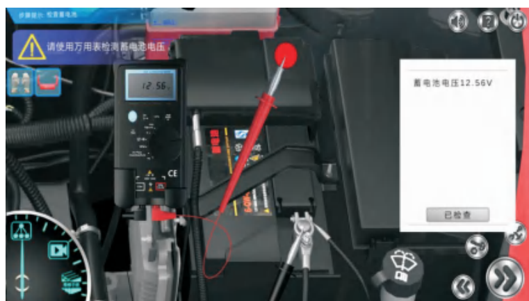
图 1-33 检查蓄电池电压
